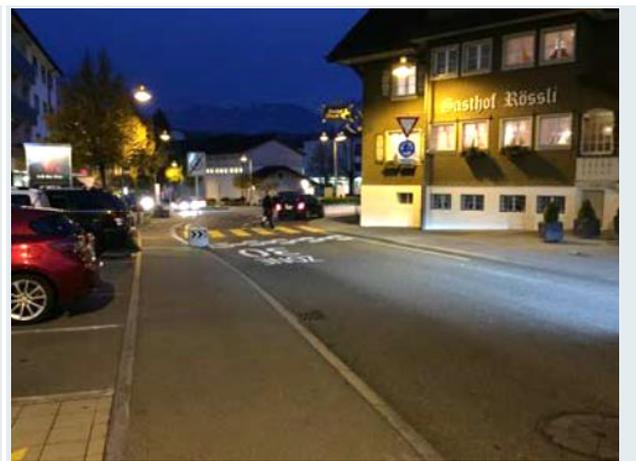
**Abb. 10** Torsituation mit seitlicher Einengung
