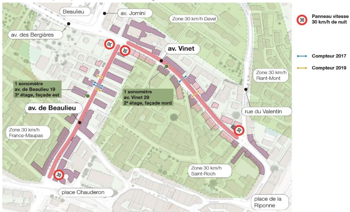
**Abb. 101** Plan de situation et localisation des comptages/mesures avec en orange les secteurs limités à 30 km/h de nuit et en vert les zones 30 (sources : Transitec Ingénieurs-Conseils SA)
